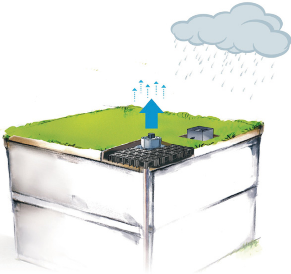
Illustration eines Retentionsdachs mit Smart Flow Irrigation SFI 40.
