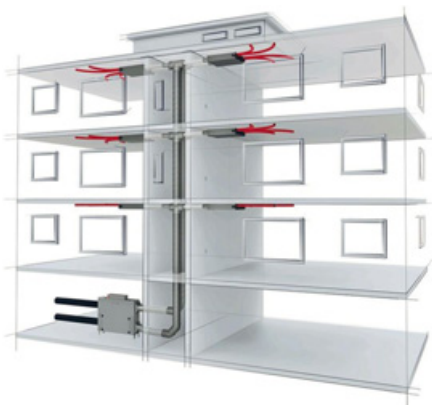
Das ValloFlex Luftverteilsystem mit den Flat Boxen von Vallox versorgen jede Wohneinheit mit genau der richtigen Menge an frischer Luft. Bild: Vallox GmbH
