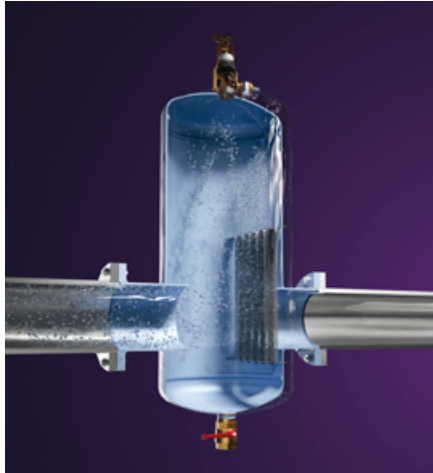
Der neue Luftabscheider Zeparo Aero der Produktmarke IMI Pneumatex wird waagrecht eingebaut. Die Blasen steigen an den Leitlamellen an die Oberseite des Abscheiders auf und werden über ein Ventil entlüftet. Bild: IMI
