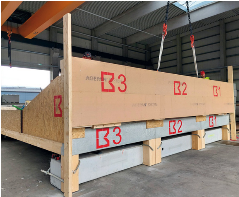
Der Experte für hybride Bauweisen, Brüninghoff, optimiert und entwickelt seine hybriden-Decken- und Wandelemente stets weiter. Der aktuelle Versuchsaufbau besteht aus drei Deckenelementen, Stützen und Fassade. Foto: Brüninghoff
