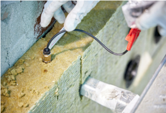
Die Sensoren zur Feuchtemessung in den Systemen wurden in der Dämmebene angebracht.
