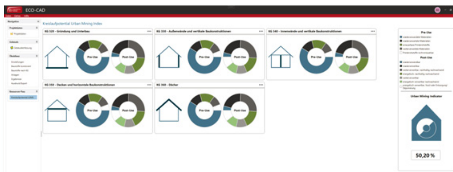
Präzise Berechnungen der Gebäuderessourcen nach dem Urban Mining Index (UMI) mit ECO-Pass Abbildungen: Hottgenroth Software AG
