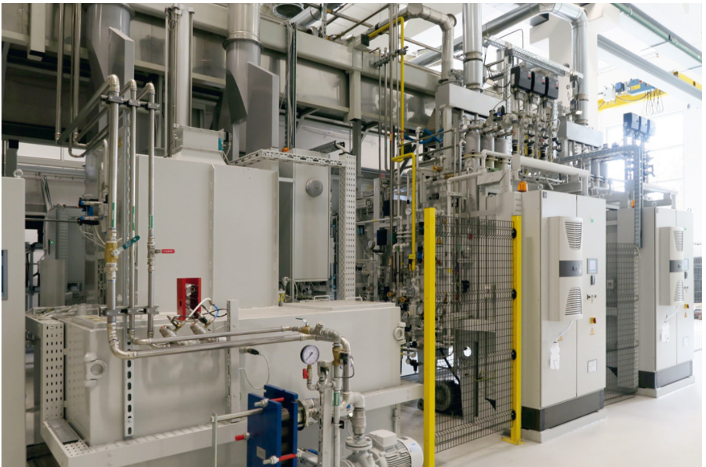
Die Roh-Werkstücke zur Zangenfertigung durchlaufen bei KNIPEX eine Vergütelinie. Hier werden sie in verschiedenen Öfen gehärtet.
