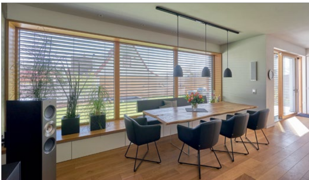
Gewachste Eichendielen verleihen dem Haus eine warme Atmosphäre. An den Wänden reguliert Kalkputz die Raumfeuchte. Die Jalousien stellen sich dank KNX-Gebäudeautomation selbstständig so ein, dass der Sonnenschutz gewährleistet ist und der Raum dennoch Tageslicht erhält.
