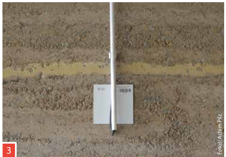
Bild 1: Die Heizzentrale des Naturinfozentrums (NIZ) mit Sole-Wasser-Wärmepumpe. Bild 2&3: Die 30 Meter lange Lehmwand mit einem U-Wert von 1,5 speichert die Sonnenwärme. In einem Forschungsprojekt werden Oberflächentemperaturen und Wärmedurchgänge gemessen.
