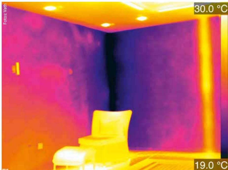
*Wärmebild einer Gebäudecke: Geometrische Wärmebrücke in einem Hallenschwimmbad mit Feuchteschäden und Schimmelpilzbefall*
